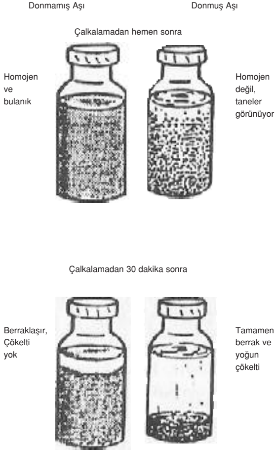
Şekil 1- Sıvı halde bulunan aşıların donma açısından kontrolü (çalkalama testi).
