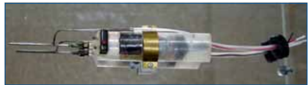
Resim 7: Robert Machemer'in geliştirdiği vitreus-infusion-suction-cutter (VISC) cihazı aspirasyon, kesme ve infuzyon fonksiyonlarını bir arada gerçekleştiriyordu.
