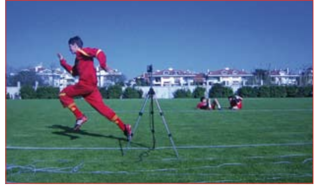
Resim 6: Saha ortamında uygulanan sürat testi. Fotosellerin yerleştiriliş şekline göre başlangıç noktasından istenen mesafelerde elde edilen sonuçlar bilgisayar ortamında izlenebilir. Aynı sistem kullanılarak şut sırasında topun hızı, reaksiyon zamanı, dikey sıçrama testleri de yapılabilir.
